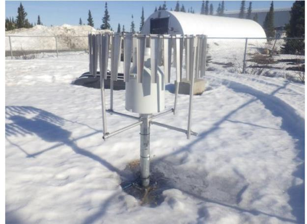
**Photo 3.2** Pluviomètre situé à proximité de la tour météorologique (avril 2021)
