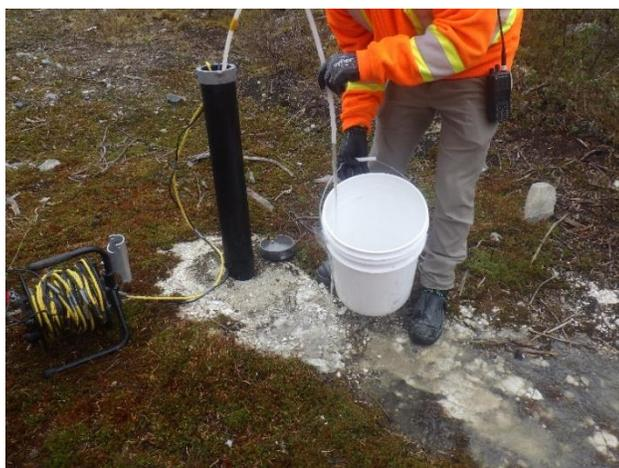
**Photo 3.53 Échantillonnage d'eau souterraine au LEET (juin 2021)**
