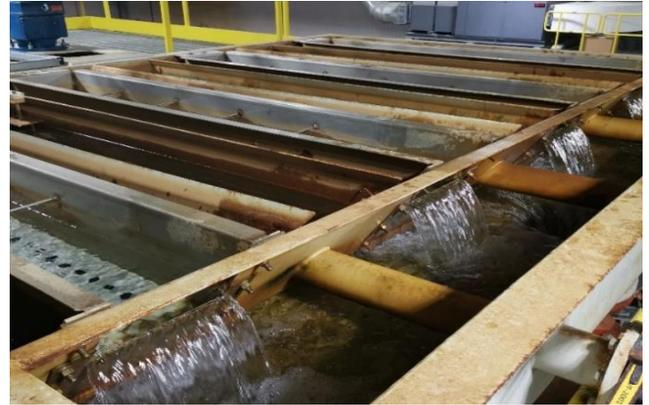
**Photo 3.49 Aspect visuel de l'eau traitée à la sortie des décanteurs lamellaires**
