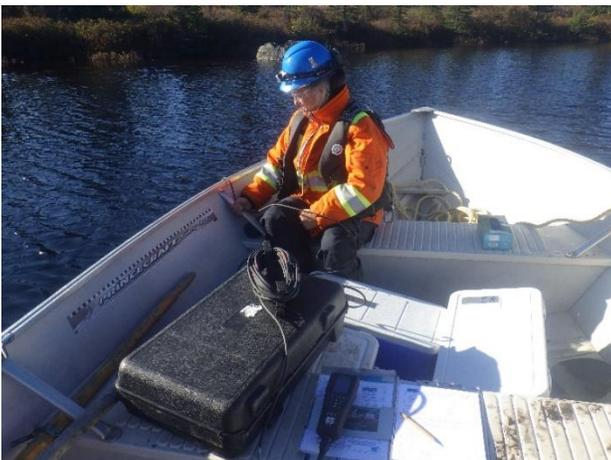
**Photo 3.20** Mesure d'un profil vertical de la qualité de l'eau (octobre 2021)
