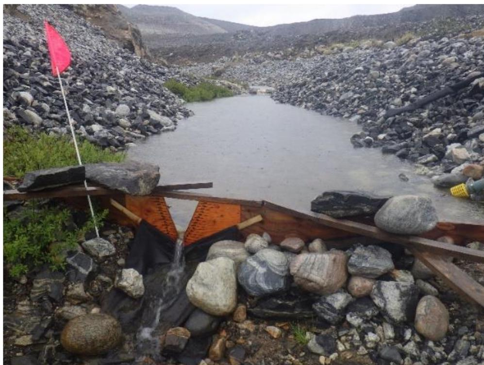
**Photo 3.28 Déversoir gradué en V dans l'exutoire du lac F3298**
