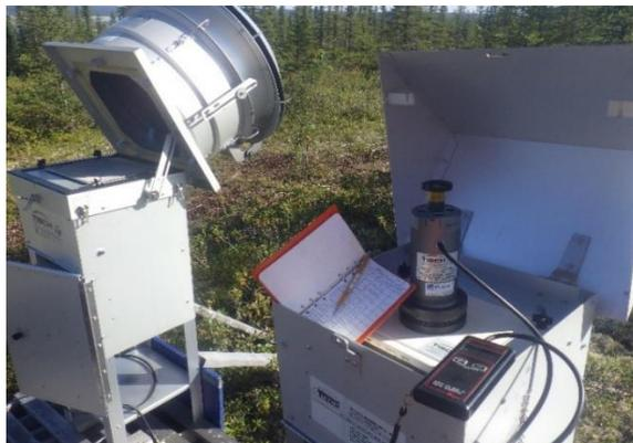
Photo 3.6 Installation du filtre d'échantillonnage et calibration du moteur
