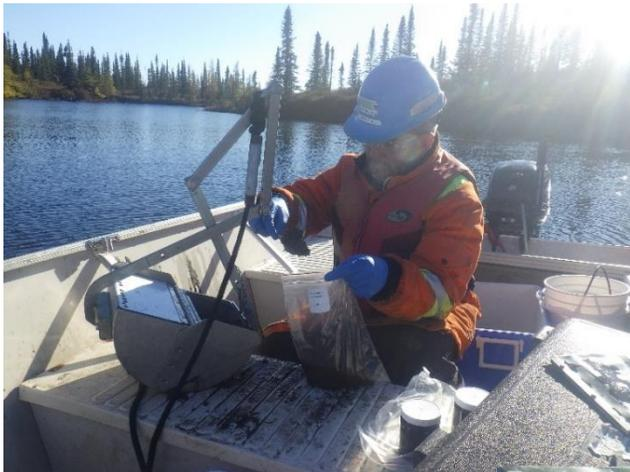
**Photo 3.19 Échantillonnage des sédiments (octobre 2021)**
