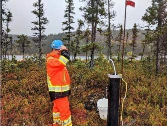
**Photo 3.49 Échantillonnage d'eau souterraine au LEET (septembre 2020)**
