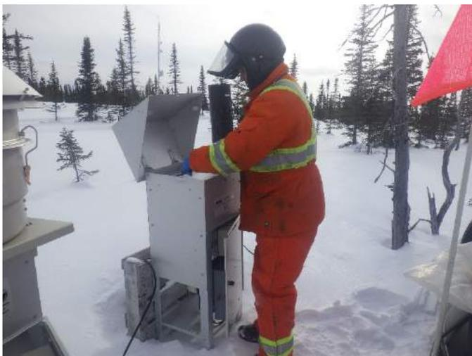
**Photo 3.6** Installation du filtre d'échantillonnage pour la qualité de l'air (février 2020)
